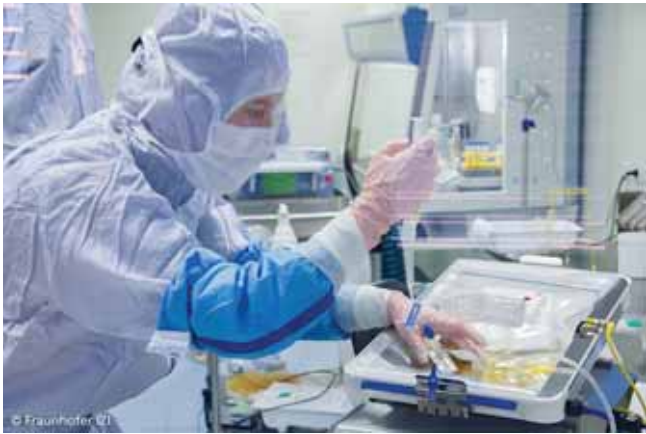
Abb. 4 ▲ Herstellung von CAR(chimärer Antigenrezeptor)-T-Zellen in der pharmazeutischen Reinraumanlage (insgesamt 21 Reinnräume, biologische Sicherheitsstufe/Schutzstufe S2) des Fraunhofer IZI (Institut für Zelltherapie und Immunologie) gemäß Good Manufacturing Practice (GMP) in Leipzig. (Mit freundl. Genehmigung, © Fraunhofer IZI, alle Rechte vorbehalten)
